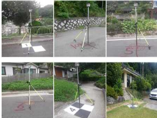
그림 2. GCP 상의 VRS RTK GPS survey Fig. 2. the VRS RTK GPS survey on GCP
