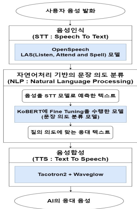
〈그림 6〉 AI 한국어 음성 챗봇 시스템 인터페이스 구성도
