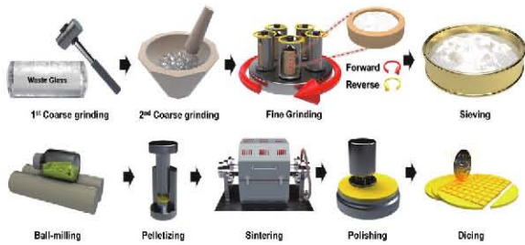
그림 4. 재활용 PiG 제조 공정도
