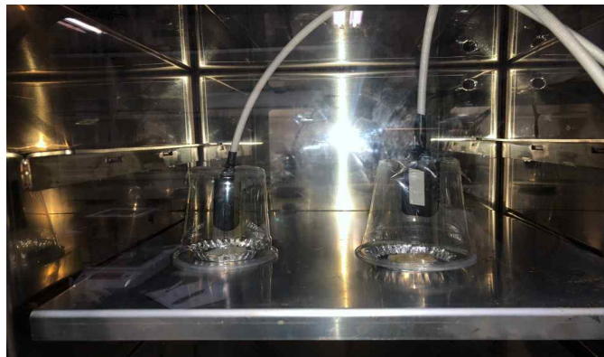
<그림 2> 온.습도 센서와 플라스틱컵 패키징 상태
