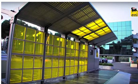
그림 5. LSCs를 이용한 Domal smart windows의 실증사례, Milan Design Week 2018 (source: Eni)<sup>[12]</sup>
