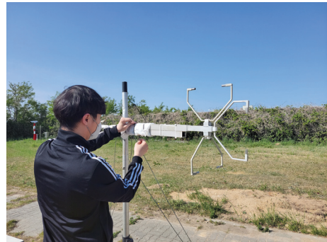
그림 8. 3차원 초음파풍속계 설치 Fig. 8 Installation of 3D ultrasonic anemometer
