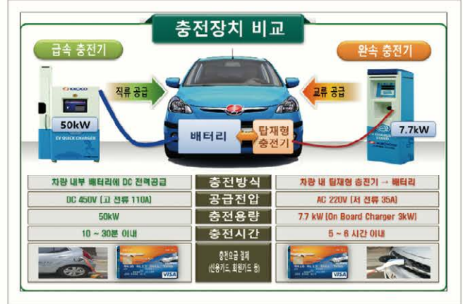
그림 7 전기자동차 충전 인프라 전체 시스템 개요
