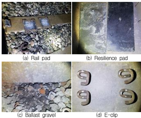
그림 5. 시료 채취구간 전경 Figure 5. Photographs of specimens in field
