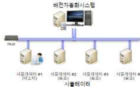
그림 6. 배전자동화 시뮬레이터 구성도[기 Fig. 6. Distribution automation simulator configuration diagram
