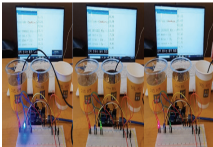
그림 5. 온도에 따른 LED 색상 변화 Fig. 5 LED color changes depending on the temperature
