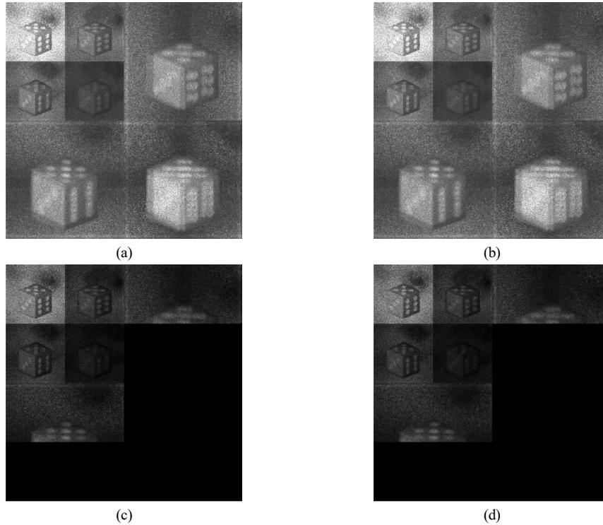
그림 2. SPIHT 압축 결과 (a) 실수부, (b) 허수부, (c) 복원된 실수부, (d) 복원된 허수부
