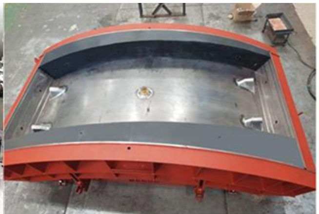
그림 3. TBM 세그먼트 거푸집 내부에 3D프린팅으로 제작한 채움재를 적용한 사진
