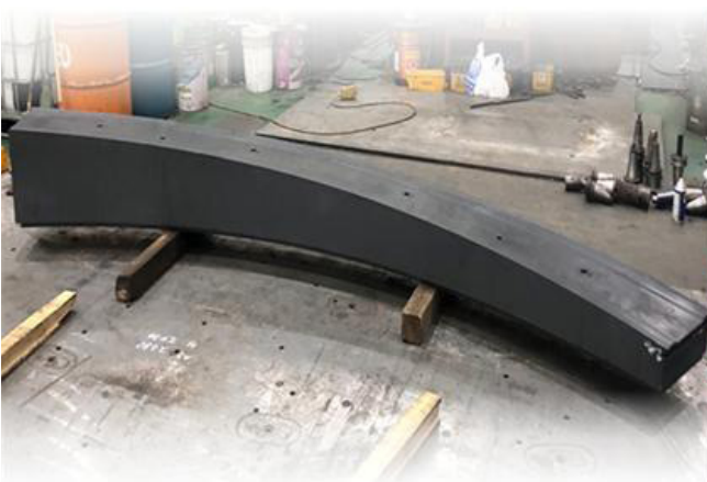
그림 3. TBM 세그먼트 거푸집 내부에 3D프린팅으로 제작한 채움재를 적용한 사진
