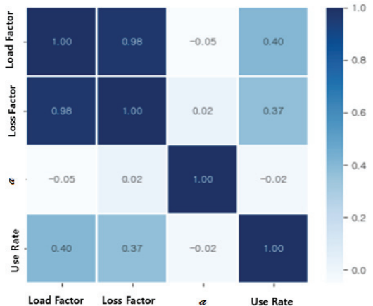
그림 6. 부하율, 손실계수 \alpha , 선로 이용률 간 상관계수 히트맵 Fig. 6 Correlation heat map between load factor, loss factor, loss coefficient( \alpha ) and feeder's use rate
