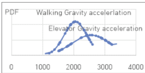
그림 3. x축 엘리베이터 이동, 걷는 상황 정규분포도 Fig. 3 X-axis elevator movement, walking situation normal distribution
