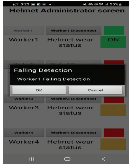
그림 7. 낙상 및 추락 알람 신호 Fig. 7 Fall down alarm signal
