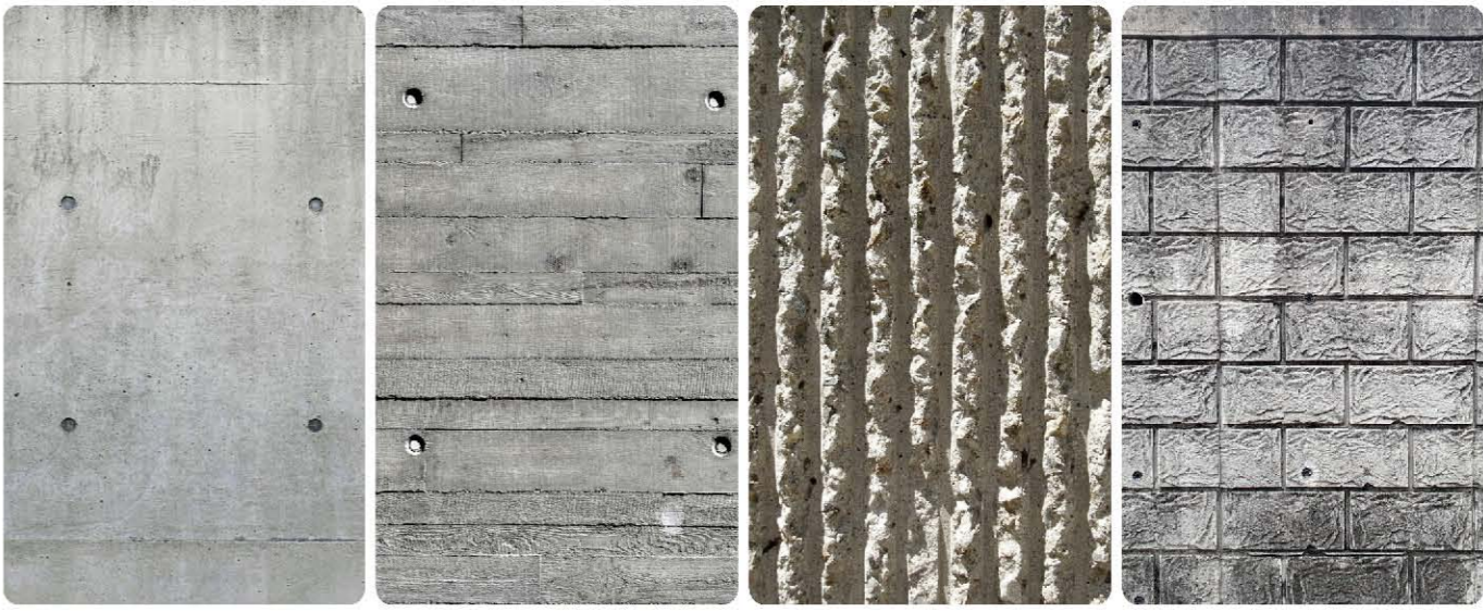
철판 거푸집 콘크리트 나무널 거푸집 콘크리트 세로 줄무늬(fluted) 콘크리트 돌 무늬 콘크리트
