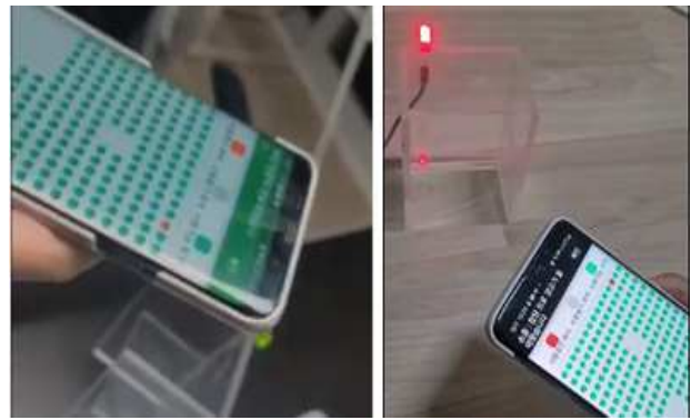
(a) First screen. (b) Second screen. 그림 8. 블루투스 통신 연결에 따른 예약 좌석의 IoT-LED 점등 Fig. 8. IoT-LED turn-on of reserved seat according to Bluetooth communication connection.
