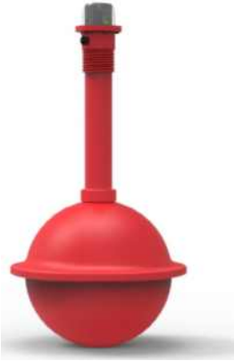
그림 2. 제작된 전자 부이의 형상 Fig. 2. Shape of fabricated electric buoy.
