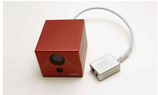
[Fig. 5] Example of an array-based 3D LiDAR [그림 5]. 어레이 기반 3D LiDAR의 예 ETRI GEN3
