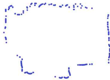
[Fig. 8] Example of outputting 2D LiDAR profile to Python Turtle library [그림 8]. 2D LiDAR 프로파일을 Python Turtle 라이브러리로 출력한 예
