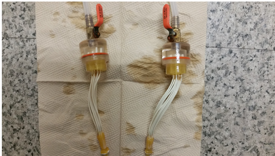
Fig. 3. UF (ultrafiltration) membrane module.
