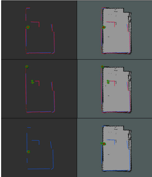
(그림 7) 라이다를 이용하여 물체 추정 결과 (Figure 7) The Result of the object detections using the LiDAR sensor
