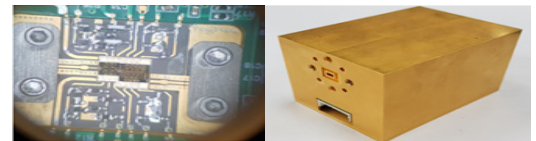
그림 4. W-대역 MMIC 칩을 적용한 수신용 모듈 형상 Fig. 4. Configuration of receiver with W-band MMIC chips
