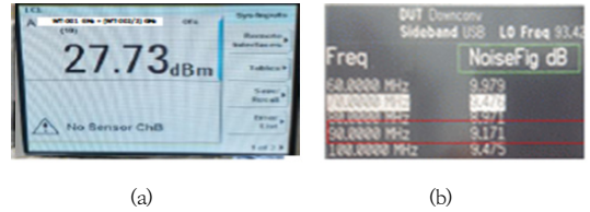
그림 7. 송신모듈(a)와 수신모듈(b) 측정 결과 Fig. 7. Test Results of Tx Module(a) and Rx Module(b)
