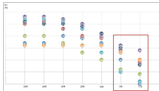
그림 11. 50 ft에서 접지까지 N1 추진력 트렌드 Fig. 11. N1 Thrust trend from 50 ft to T/D.
