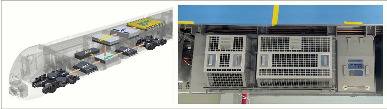
그림 5 수소연료전지 철도 차량 VVVF-SiC 인버터(1C1M 2ea)
