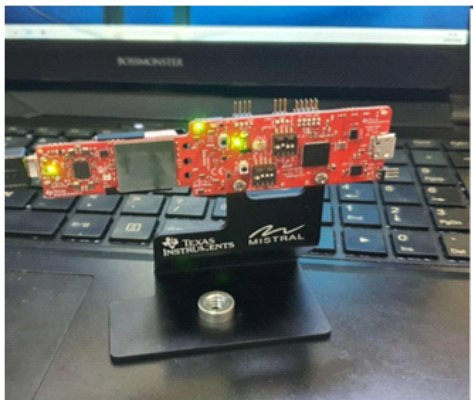
그림 9. 비접촉식 생체 징후 측정 기기(TI IWR6843) Fig. 9. Non-contact Biometric Signal Measuring Device(TI IWR6843)
