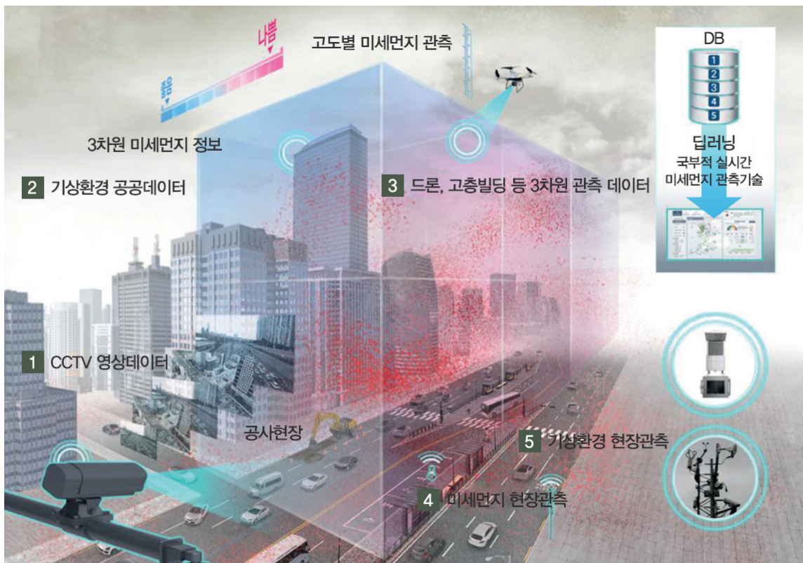
그림 4. CCTV 영상데이터를 활용한 미세먼지 관측 기술 개념
