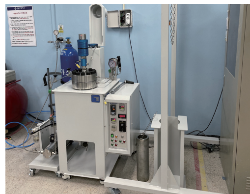
(b) 초임계 CO 2 Reactor 설치 예시
