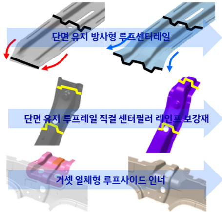
Fig. 5 기존(분리형)구조와 개선(일체형)구조의 부품 변경사항
