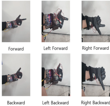
그림 10. 손동작에 따른 차량 동작 Fig. 10 Vehicle motion according to hand motion
