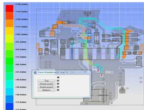
그림 4. 무선충전컨트롤모듈 임피던스 스캔
