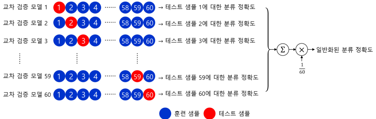
그림 2. 일반화된 분류 정확도를 계산하기 위한 LOOCV Fig. 2. LOOCV for estimating generalized classification accuracy
