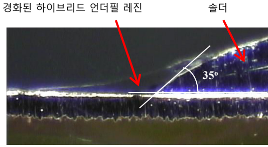
그림 12 하이브리드 언더필 리플로우 공정 후 솔더 단면 사진
