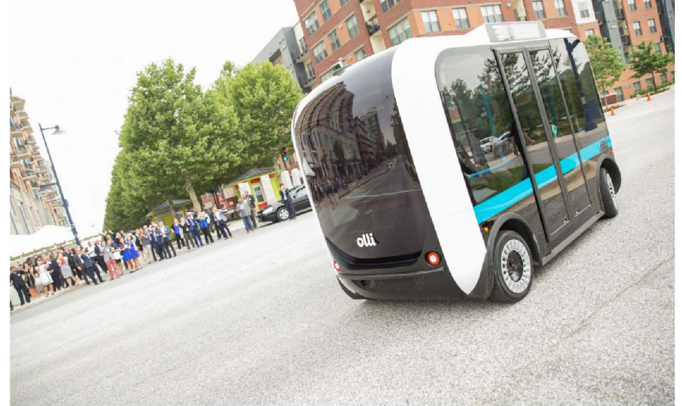
미국 스마트업 기업 로컬모터스가 개발한 '올리(Olli)'라는 이름의 자율주행차. 스마트폰앱에 출발지와 도착지를 입력하는 승객수요에 따라 서둘러 오간다. IBM의 슈퍼컴퓨터 '왓슨' 플랫폼을 내장해 탑승객과 대화를 나누기도 한다. 로컬모터스는 온라인 커뮤니티에서 나온 아이디어를 토대로 3D프린팅 작업을 거쳐 개인 맞춤형 전기차를 만들어준다. © Local Motors 웹사이트
