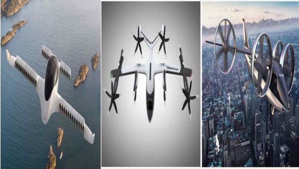
그림 13. 틸트 윙(Lilium jet), 틸트 로터(S-A1), 틸트 덕트(NEXUS 4EX)형 eVTOL [5][22][23]
