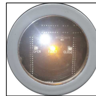
그림 18. 밸브 오류 LED 상태 Fig. 18. Valve error LED status
