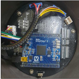
a) 액추에이터 제어보드 a) Actuator control board
