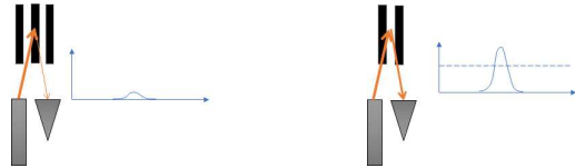
그림 3. 반사율이 낮은 곳과 높은 곳의 반사광 차이 Fig. 3. Difference in levels of reflection from a black surface and one from a white surface
