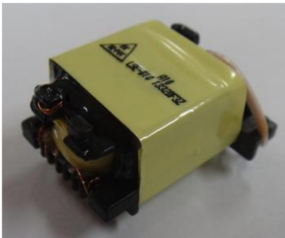
Fig. 2. Actual appearance of conventional Flyback transformer. 그림 2. 기존 Flyback 변압기의 실제 외관
