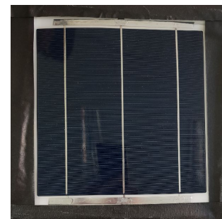
(b) ETFE Film 1 cell PV module
