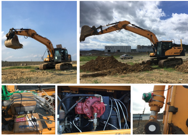
Fig. 8 20톤급 굴착기 실차시험
