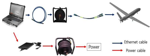
그림 3. 비행체점검장비와 비행체 간 연결 구성도 Fig. 3. Connection diagram of AVTE for UAV
