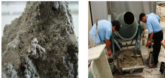
(d) Visual inspection of slump loss with time
