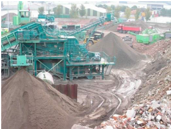
그림 2. 건설 및 철거폐기물 재활용 플랜트
