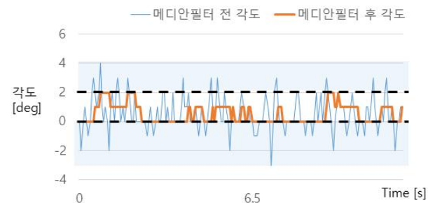
Fig. 14. The angle of using median filter before and after. 그림 14. 메디안 필터 적용 전, 후 각도
