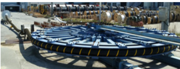
그림 5 다이내믹 케이블 Type Test : Static
