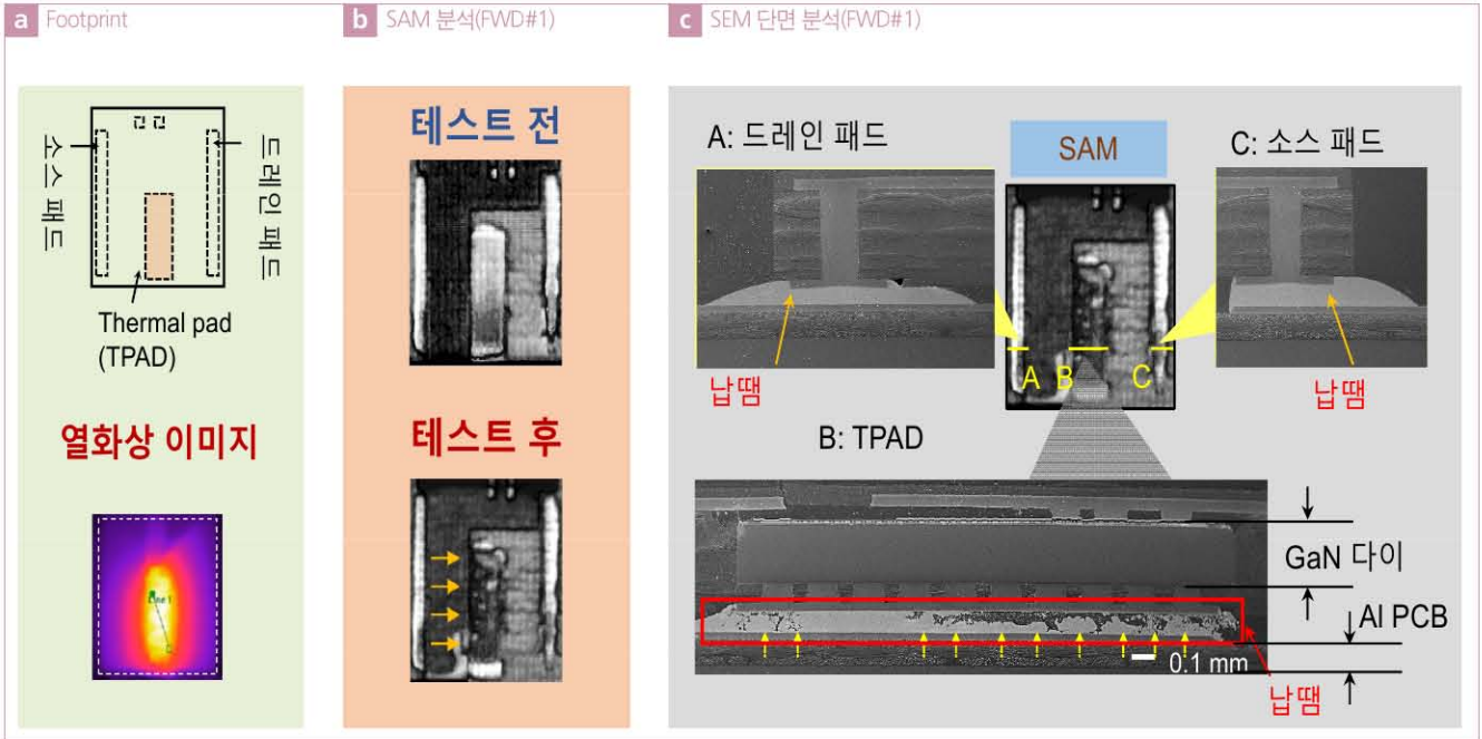
그림 3 (a) GaN 소자 footprint & 열화상 이미지, (b) FWD#1의 파워사이클링 테스트 전후 솔더 접합층SAM 분석 결과, (c) FWD#1의 소스 패드, 드레인 패드, TPAD 위치의 SEM 단면 분석 결과
