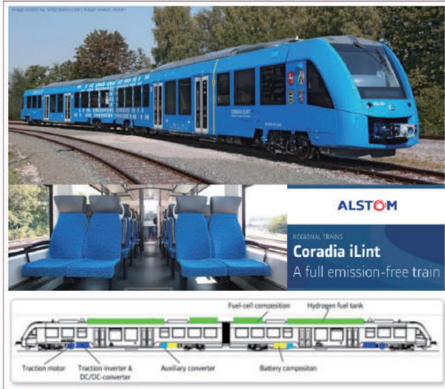
그림 8 프랑스의 수소연료전지 여객열차 및 구성
