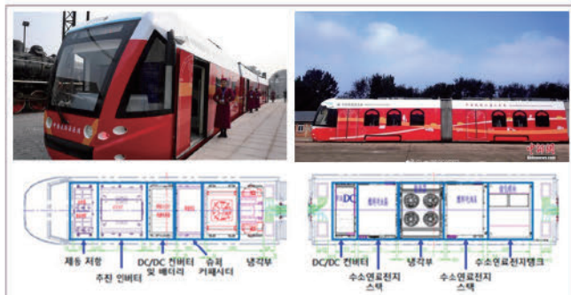
그림 11 중국의 수소연료전지 트램 및 구성
