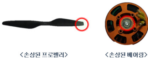
(그림 4) 손상된 프로펠러와 베어링 (Figure 4) Damaged propeller and bearing
