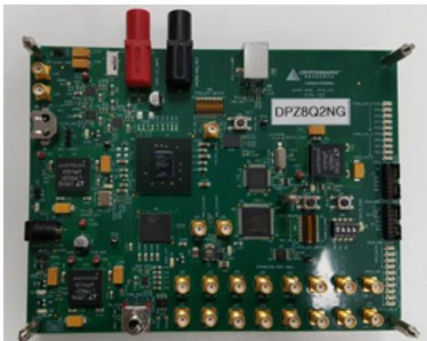
(그림 1) DPAD FPGA 암호 시험 평가 보드
