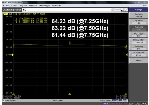
Fig. 19. Gain Characteristic of LNB. 그림 19. LNB의 이득 특성
