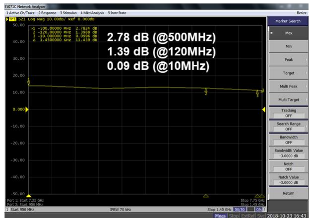
Fig. 20. Gain Flatness Characteristic of LNB. 그림 20. LNB의 이득 평탄도 특성
