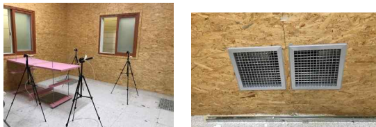
그림 5 실내 측정광경 및 디퓨저 (벽면급기)
