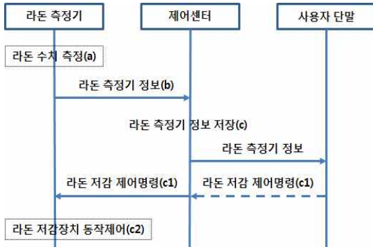
<그림 7> 라돈 저장장치를 포함한 IoT 기반 라돈 측정기를 이용한 제어방법
